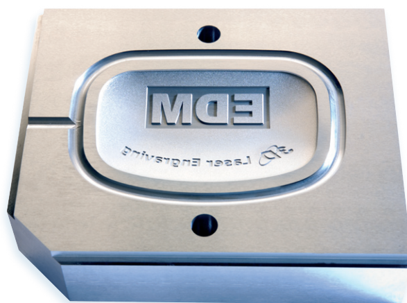
MUOTTIVALMISTUS logo- ja tekstikaiverrus muottipinnalle
