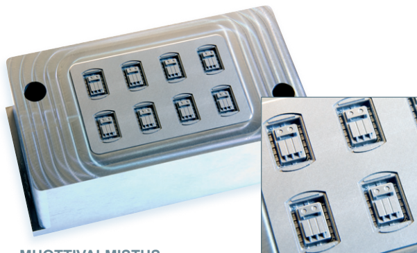
MUOTTIVALMISTUS muottipesiä teknisessä ruiskuvalumuotissa
