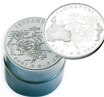
KOLIKKO- JA MITALITYÖKALUVALMISTUS kolikkumuototyökalu hopeajuhlarahalle
