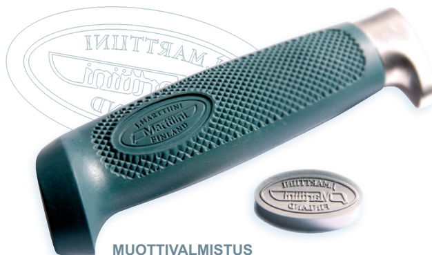
MUOTTIVALMISTUS muotti-insertti logokaiverruksella
