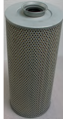
H15190/n Ø=150 mm H=365 mm D=32 mm Suod.kyky=10 µm Tähtimuoto-paperi Reikäpeltivaippa LANKA/UPPO
