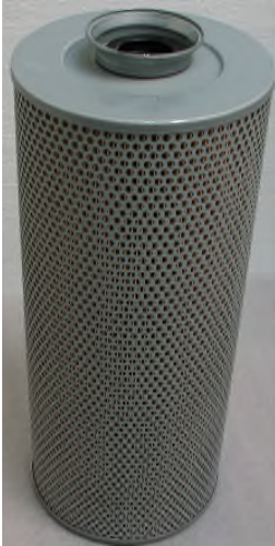
H15190/6 Ø=150 mm H=365 mm D=32 mm Suod.kyky=<5 µm Tähtimuoto-paperi Reikäpeltivaippa LANKA/UPPO
