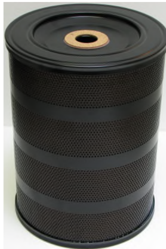
4300 0311008 Fanuc suodatin Ø=340 mm H=443 mm D=46 mm Suod.kyky=<3-5 µm Tähtimuoto-paperi Reikäpeltivaippa LANKA
