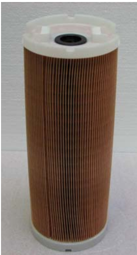
H15190/16 Ø=150 mm H=365 mm D=32 mm Suod.kyky=<5 µm Paperikiekko UPPO
