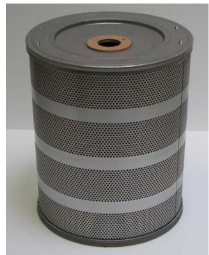
H341158/8 Ø=340 mm H=450 mm D=46 mm Suod.kyky=<3-5 µm Tähtimuoto-paperi Reikäpeltivaippa LANKA Saatavana myös muovirungolla: H34 1750/3
