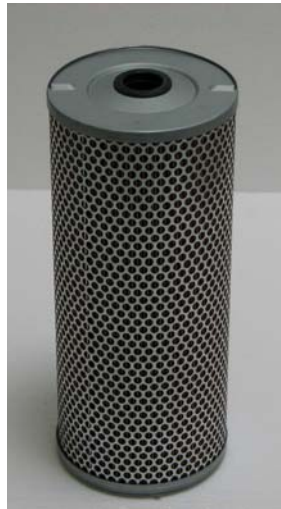
CFE 3515 vastaava kuin(H15190/6) Ø=150 mm H=365 mm D=32 mm Suod.kyky=<5 µm Tähtimuoto-paperi Reikäpeltivaippa LANKA/UPPO
