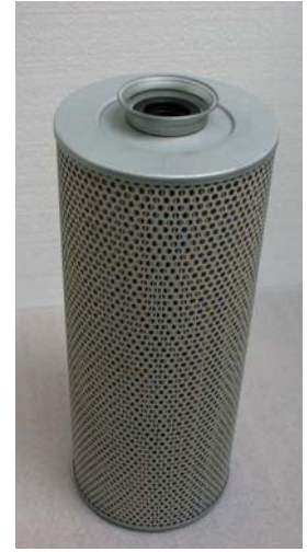
(H15190/n) Ø=150 mm H=365 mm D=32 mm Suod.kyky=10 µm Tähtimuoto-paperi Reikäpeltivaippa LANKA/UPPO
